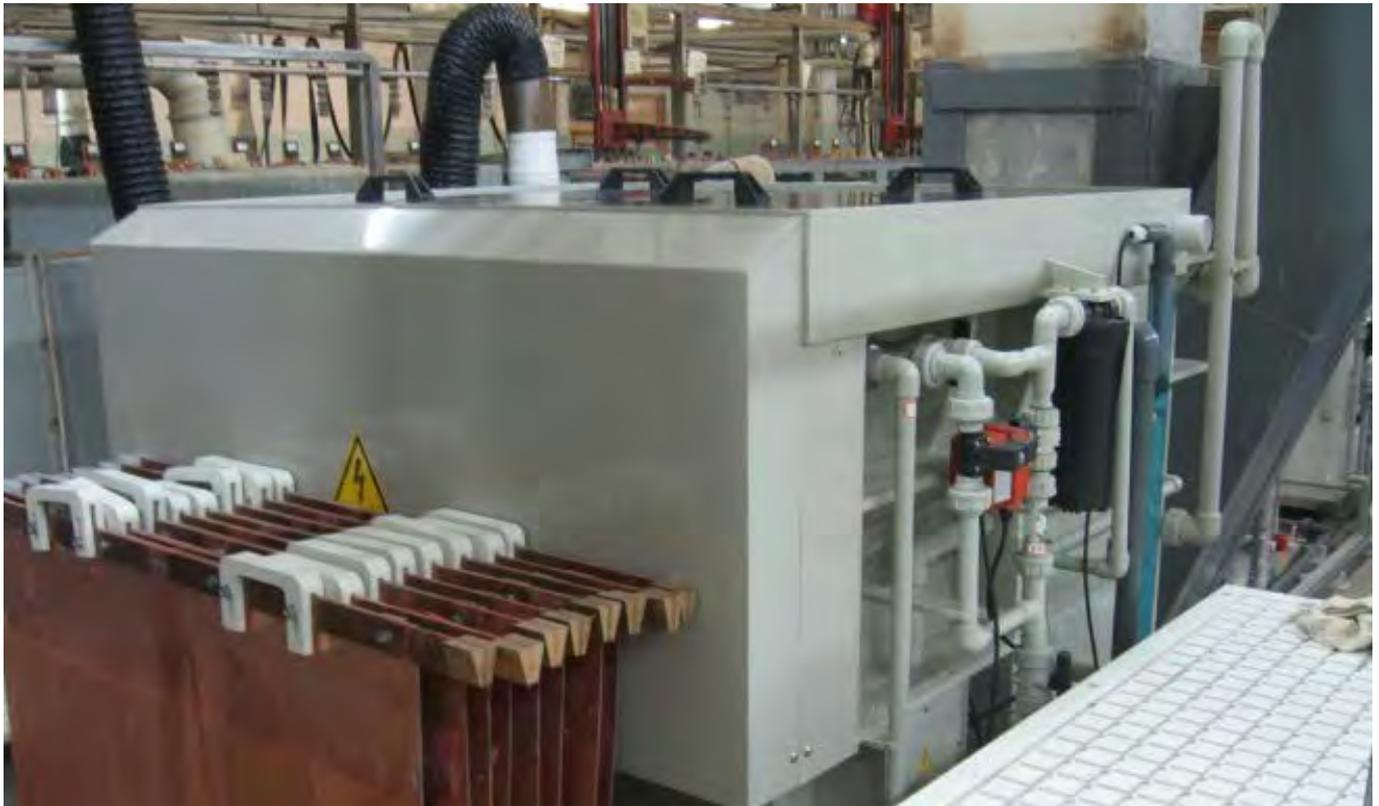
Пример практической реализации разработанных технологий и технических решений. Установка для переработки медно-аммиачных растворов травления печатных плат (технология SX-EW): общий вид и электролизёр для выделения меди (разработчик Губин А.Ф.).
