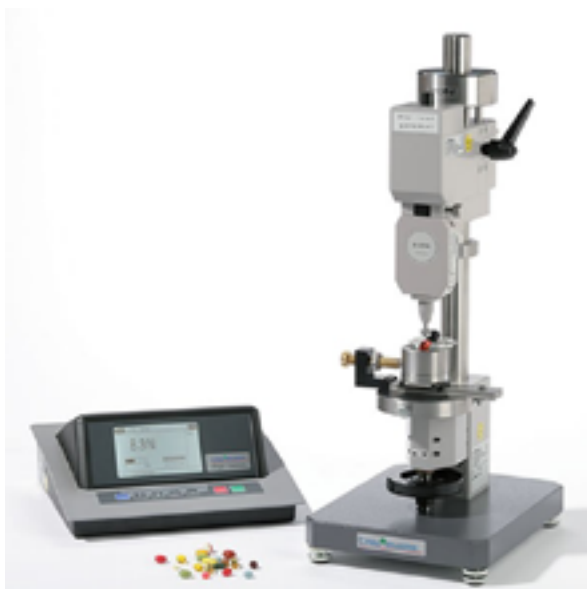
Измерение прочности геля на твердомере Gelomat
