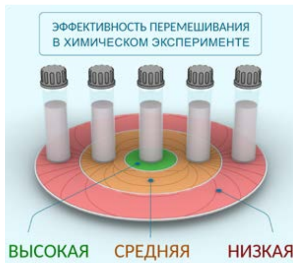
Рис.3. Области платформы магнитной мешалки с различной эффективностью перемешивания.
