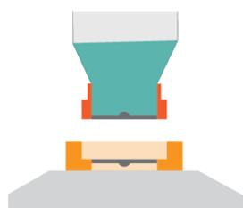
**1** Активные и пассивные блоки состыкованы. Каждая половина клапана включает в себя одну половину дискового затвора. Каждый блок герметичен и не может быть открыт, если блоки не состыкованы.
