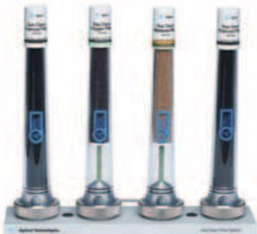
Использование газового фильтра большой емкости производства Agilent поможет поддерживать линии передачи газа чистыми и герметичными и обеспечить самые высокие требования к качеству газа. Дополнительная информация на странице [www.agilent.com/chem/gasclean](http://www.agilent.com/chem/gasclean)
