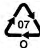
Код SPI 07 обозначает «Other» («Прочее»). К этой группе относятся прочие полимерные материалы, такие, как PMP, PFA, PTFE и т.д. Компания VITLAB не использует кодовое обозначение «O», а маркирует соответствующий тип сырья кратким обозначением согласно DIN 7728, облегчая тем самым пользователю идентификацию полимерного материала.
