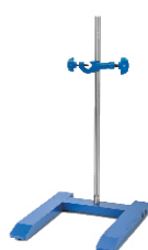
H-образный штатив с одной стойкой
