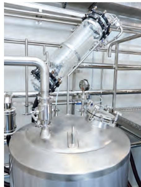
Для защиты персонала на участках, где производятся высокоактивные субстанции, были применены сплит-клапаны ChargePoint PharmaSafe. Примененные технологии позволяют работать с сухими порошками высокоактивных субстанций вплоть до веществ с OEB4 (OEL=10 мкг/м<sup>3</sup> воздуха рабочей зоны).
