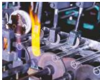
TEST TUBE MACHINE : 40000 pcs per shift
