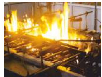
BEAKER MACHINE : 6000 pcs per shift
