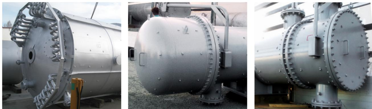
Химические реакторы из нержавеющей стали изготавливаются ёмкостью от 2л до 80 м3 используют для работы под давлением и вакуумом в самом широком спектре температур (от -80 до + 350 °С).
