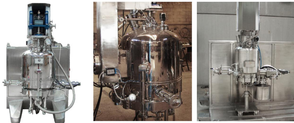
Компания «РЕАТОРГ» представляет аппарат, совмещающий в себе функции реактора, кристаллизатора, герметично закрытого фильтра и вакуумной барабанной сушилки с автоматизированной выгрузкой: переворачиваемую фильтр-сушилку, специально предназначенную для высокотоксичных или чувствительных к воздействию окружающей среды (сенситивных) материалов. Это устройство позволяет избежать потерь продукта при перемещении от одной емкости к другой, позволяя выполнять несколько стадий в одной емкости:
