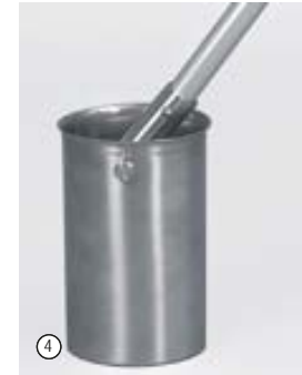
④ Маятниковый стакан, V2A Стакан автоматически возвращается в горизонтальное положение. Проба не проливается. Может быть использован для отбора проб из узких и глубоких шахт (диаметр 130 мм).
