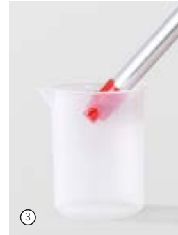
③ Маятниковый стакан, ПП Стакан автоматически возвращается в горизонтальное положение. Проба не проливается. Может быть использован для отбора проб из узких и глубоких шахт (диаметр 150 мм).
