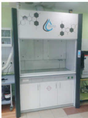
Вытяжной шкаф с ящиками из полипропилена
