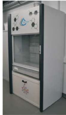
Вытяжной шкаф для шкафов безопасного хранения
