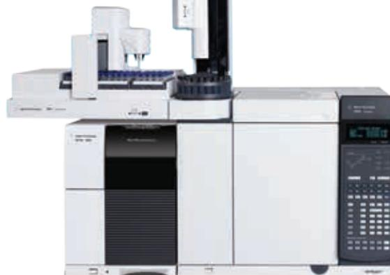
Система ГХ-МС Agilent 5977 содержит все компоненты для быстрого развакуумирования, экологических режимов расходования ресурсов и защиты системы от неправильного использования, а также может использовать водород в качестве газа-носителя.
